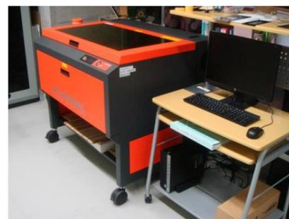
レーザー式精密加工機
